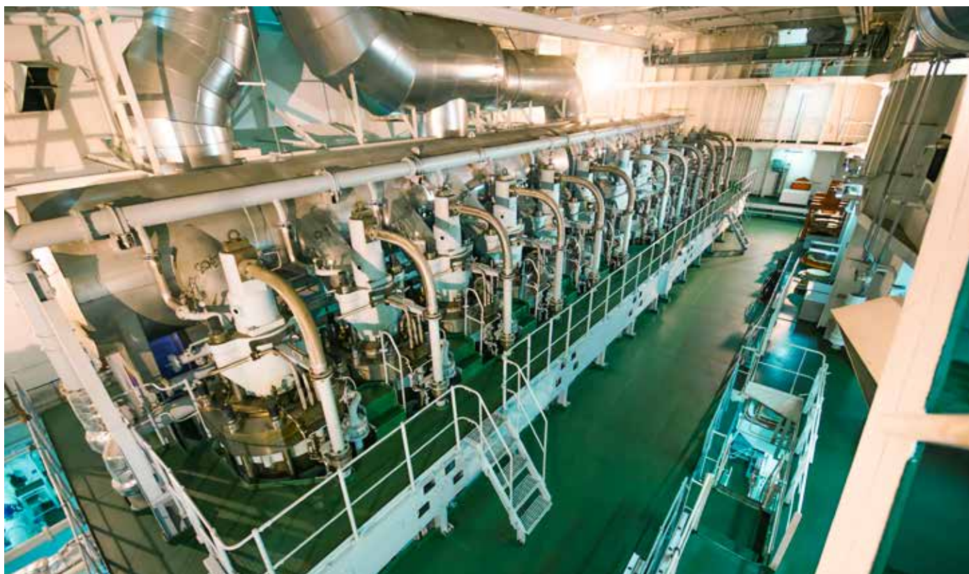
Motorhallen på ett stort fartyg där varje enhet representerar en separat cylinder.
